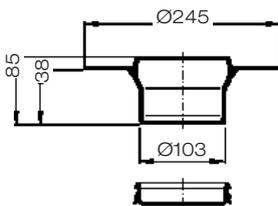
**Aufsatzelement mit Muffe**
